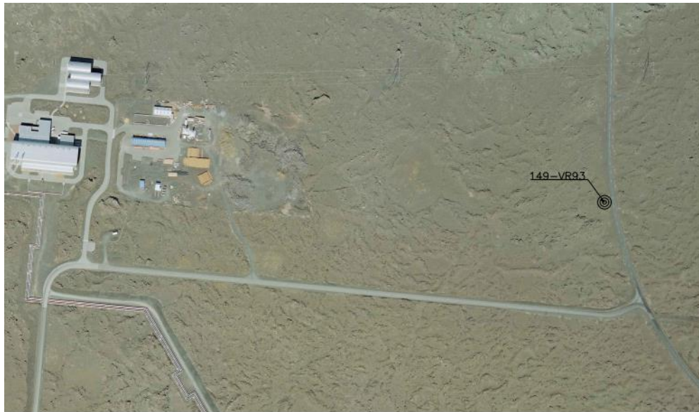
Mynd 1 Staðsetning hæðarpunkts VR93-149, koparbolti í klöpp á litlum hraunhól utan í langri beygju u.þ.b. 300 m frá veg að Reykjanesvíti, mældur '03.
